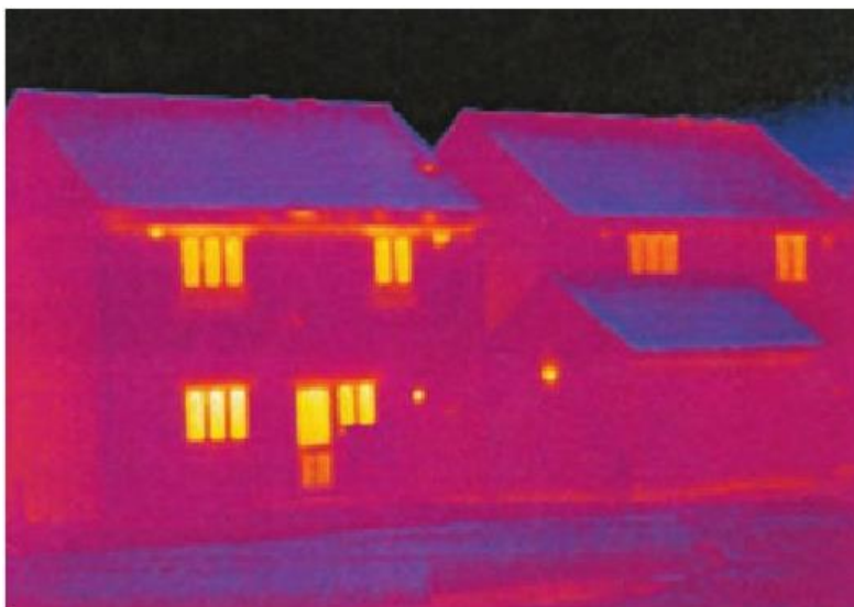
3.att. Divās dvīņu mājās Lielbritānijā, BRE Vatfordā, tika veikta infrasarkanu staru termogrāfija, lai ar faktiem apstiprinātu testa rezultātus.
